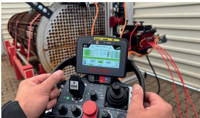
Alles im Griff: Die Steuerung des Reinigungsprozesses erfolgt per Joystick
