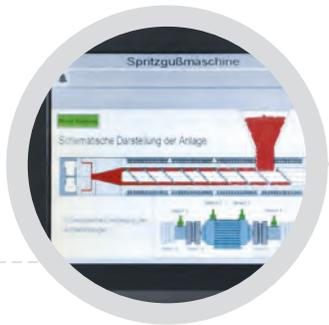
Panel des Online-Systems an der CM-Box. Hier können Daten einzelner Sensoren eingesehen werden
